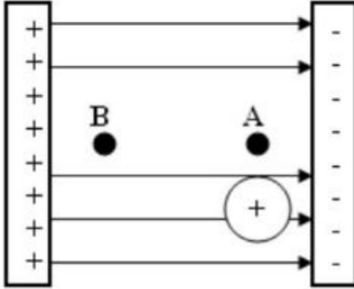
تمرير(1)ن : الشكل التالي يوضح خطوط المجال الكهربائي بين لوحين
