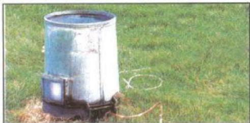
شكل (٣٣) جهاز قياس المطر
