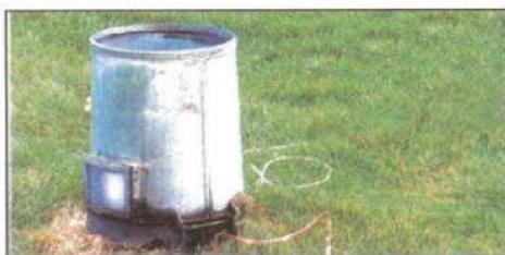
شكل (٣٣) جهاز قياس المطر
